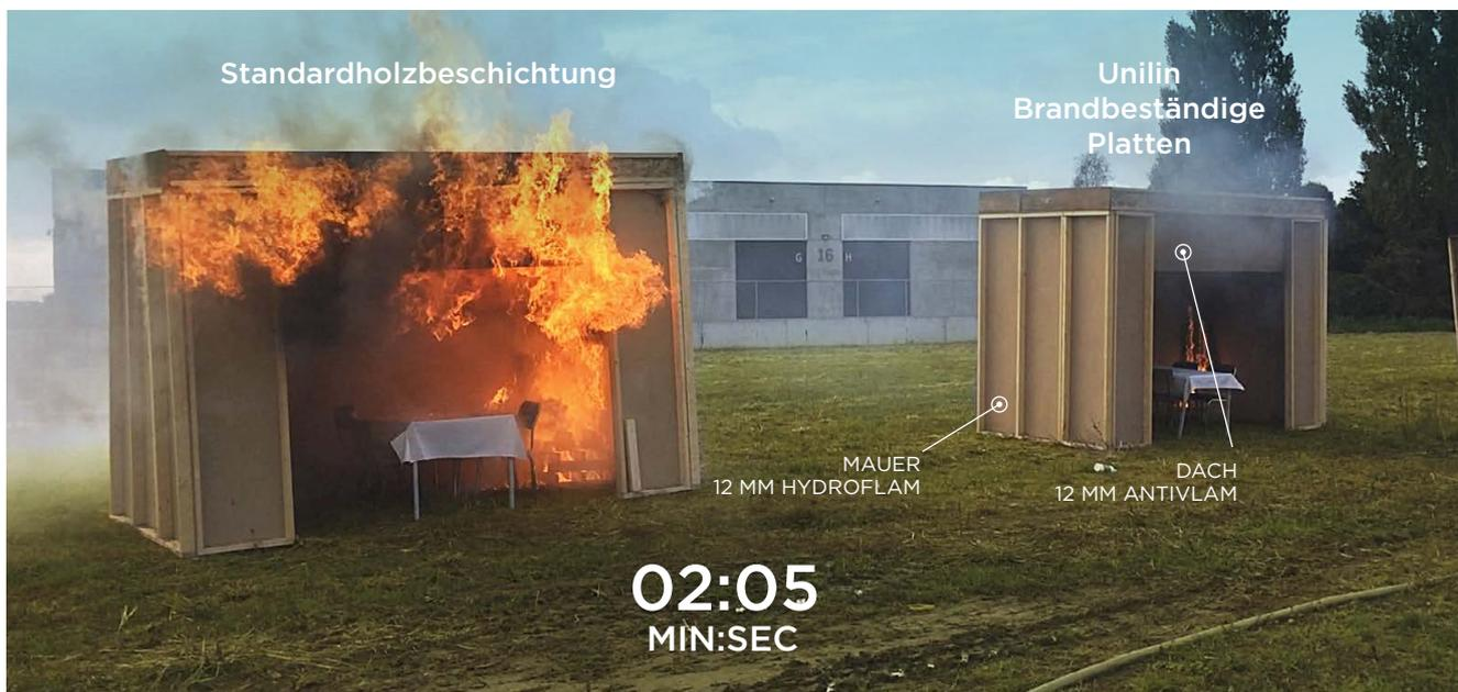
Brandschutz ist ein Muss! Bei einem Brand sind schon ein paar Sekunden extrem wichtig, für eine sichere Evakuierung. Die brandbeständigen Platten von Unilin sind bis in den Kern behandelt, um die Brandentwicklung zu hemmen. Die Entstehung entflammbarer Gase wird vermindert, wodurch der Beitrag zum Flammenüberschlag eingeschränkt wird. Hierdurch wird die (Nominale) **Verbrennungsgeschwindigkeit** der Platte stark reduziert von 0,90 mm/Min (Standard) auf **0,50 – 0,55 mm/Min.**
