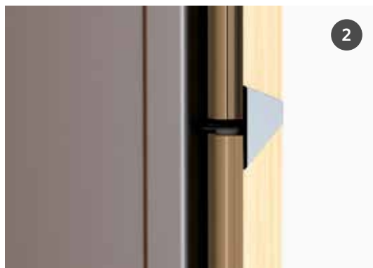
Afwerking met aluminium T-profiel
